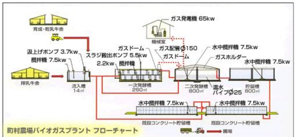
バイオガスは、ガスホルダーから伸びたガス配管を通して、隣接する自家発電施設内のガスエンジン発電機(定格出力65kw)で燃焼され、発電機の動力となります。(写真参照) 発酵期間を経た糞尿は、消化液として、鉄筋コンクリート製の貯留タンク(1,300m<sup>3</sup>×2基、800m<sup>3</sup>×1基)に収容されます。この消化液は、全量が、当農場の圃場の肥料として還元されます。現在は、牧草地を中心に、飼料用とうもろこし・小麦に利用されている圃場全てにおいて、消化液を施肥の中心として利用しています。
